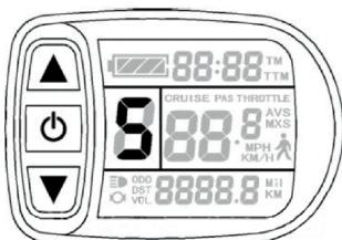
EN EL MODO DE OPERACIÓN ESTÁNDAR, EL CAMBIO DEL NIVEL DE ASISTENCIA DEL SISTEMA PAS SE REALIZA MEDIANTE LOS BOTONES:
